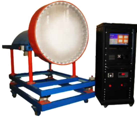
شکل ۱. آسیای آزمایشگاهی با قطر یک متر
