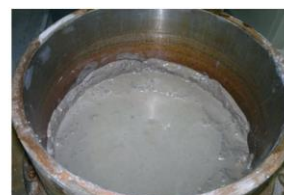
(ب) نمونه درون سیلندر خاک در حالت اشباع
