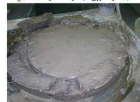
(ج) نمونه و صفحه سایشی بعد از آزمایش در حالت اشباع
