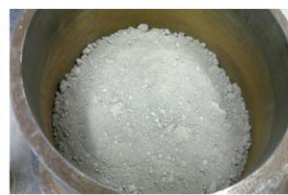
(الف) نمونه درون سیلندر خاک در حالت خشک
