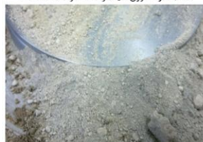
(ج) نمونه و صفحه سایشی بعد از آزمایش در حالت خشک
