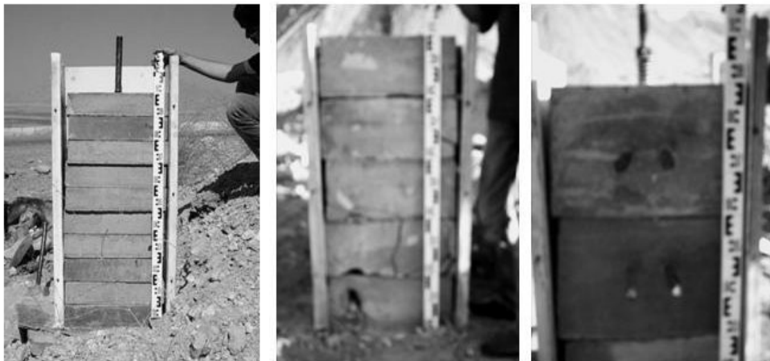
شکل ۲: جاگذاری بلوک های بتنی در قالب های فلزی.
