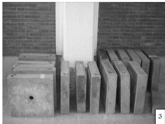
شکل ۱: مراحل مختلف مدل سازی فیزیکی در آزمایشگاه. (۱) قالب گیری (۲) عمل آوری در اتاق بخار (۳) تعدادی از بلوک های نهایی
