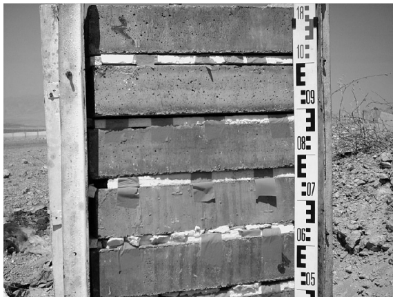
شکل ۶: استفاده از پرکننده با ابعاد مختلف به ضخامت ۲ cm.
