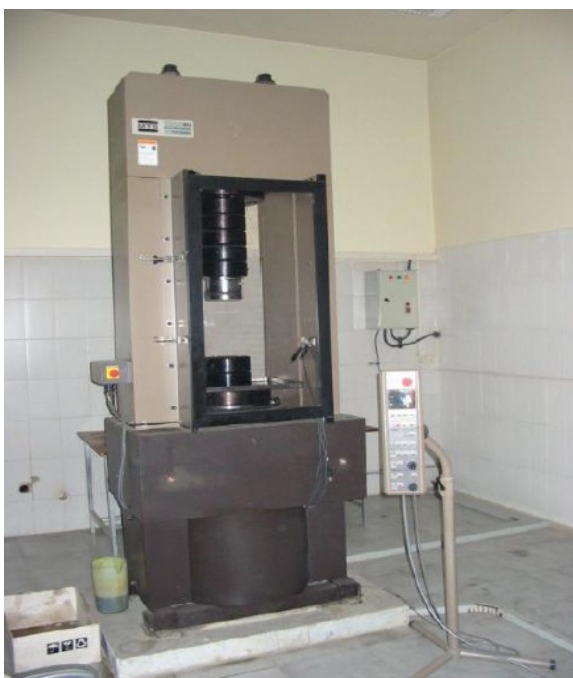
شکل ۲: تصویر دستگاه جک خود کنترل ۴۵۰ تنی ساخت شرکت MTS آمریکا
