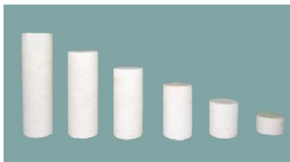
شکل ۱: تصویر یک سری از نمونه‌های تهیه شده از سنگ آهک نکا در نسبت طول به قطرهای مختلف.
