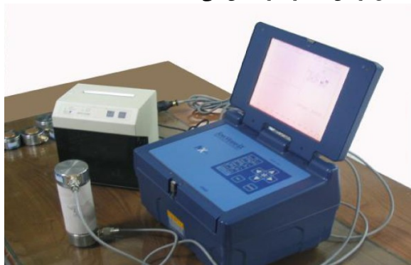
شکل ۳: تصویر دستگاه اولتراسونیک و ویرا سان‌های فرستنده و گیرنده موج
